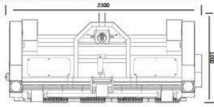
H 1800 Double Blower Hasatsan makine-miz, düz veya az eğimli arazilerde fındık, ceviz gibi ürünlerin yoğun olduğu bahçelerin hasadı için geliştirilmiştir. 35hp ve üzeri traktör ile çalıştırılabilir olmuştur. Araçların yapısı çalışanların performansı bahçenin temizliğine göre günde 20 ila 40 dönüm arasında hasat yapabilmektedir. Tane yapma özelliği bulunmamaktadır. Makinenin tam performans ile çalışabilmesi için arazinin tesviye temizliğinin yapılmış olması gereklidir.
